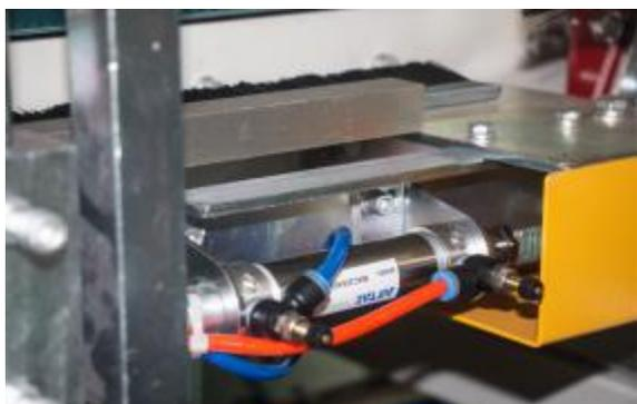
采用亚德客气缸控制，整机运行通畅，封箱速度快，适合配套后道包装流水线全天候封箱。
