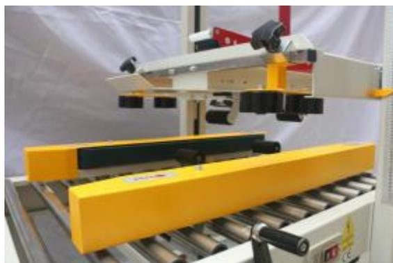
采用纸箱压板抚平设计，防止纸箱翘起，让纸箱与胶纸完美贴合，封箱美观，胶纸不易起泡
